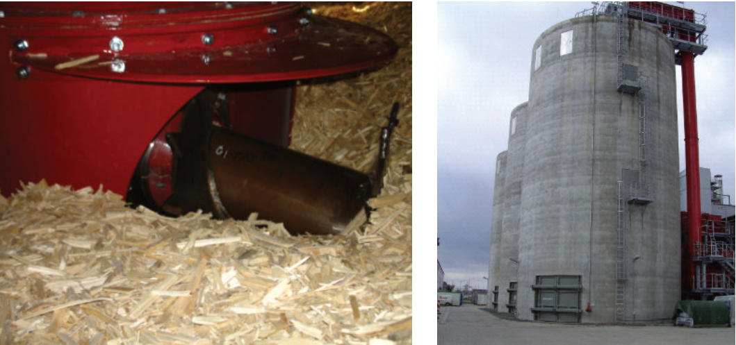
SILAS-3 zur Austragung von Biomasse/Hackschnitzel als Sonderlösung in einem Stahlbau
