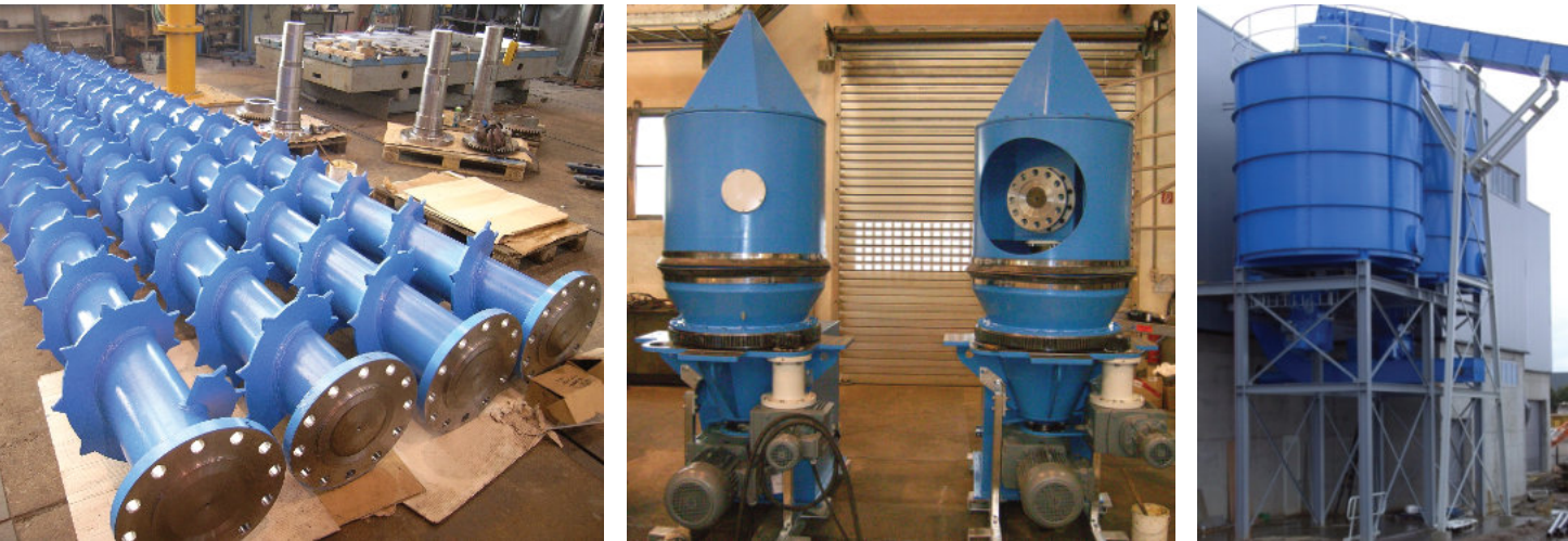
SILAS-3 zur Austragung von Biomasse/Hackschnitzel als Sonderlösung in einem Stahlbau
