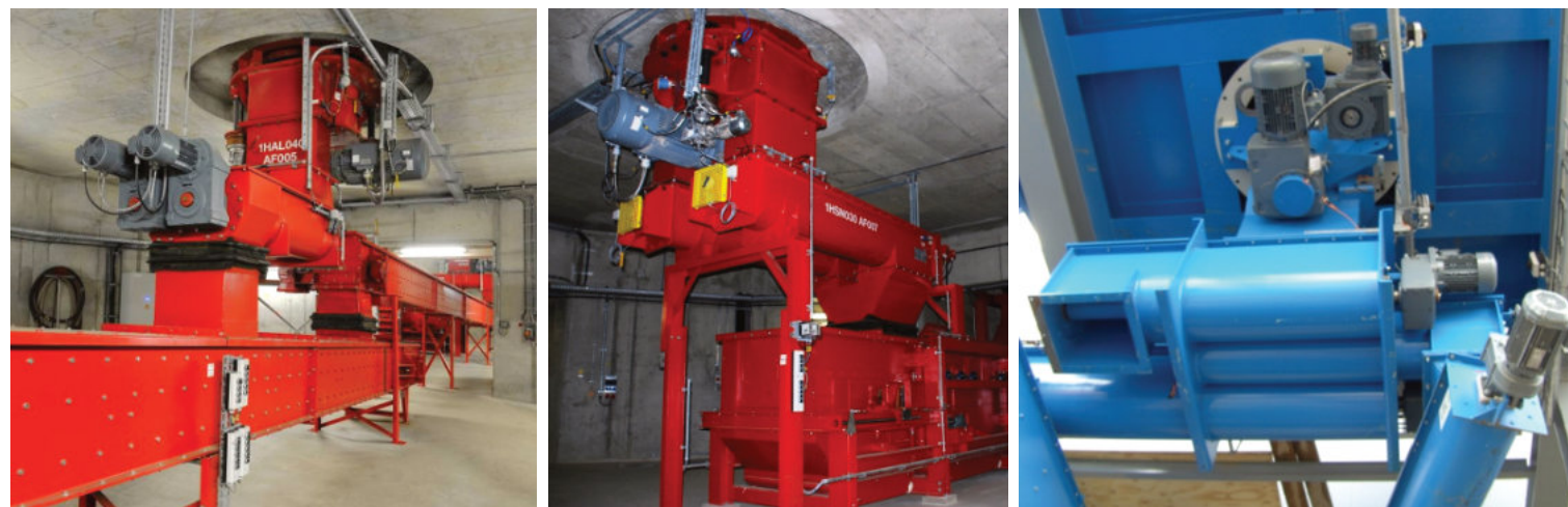
Diverse Ausführungen von Dosierschnecken mit und ohne nachfolgende Fördertechnik
